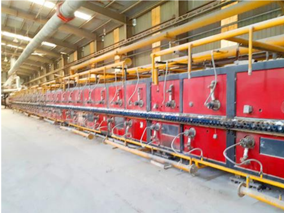
Hình 6: Hệ thống lò nung thanh lăn tại nhà máy gạch Granite Nam Định
