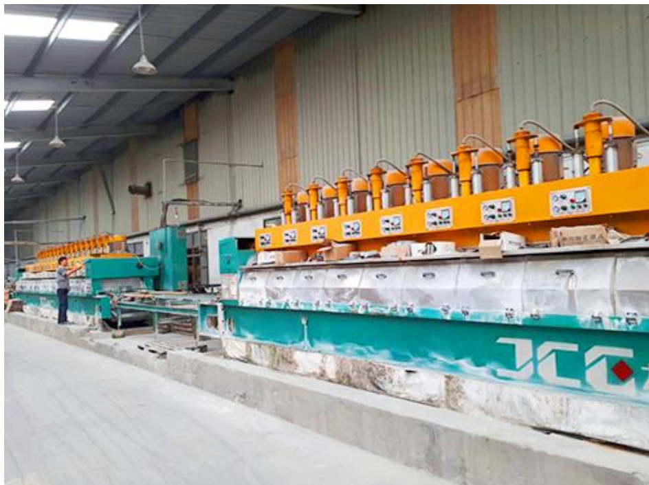
Hình 7: Hệ thống mài đánh bóng sản phẩm tại nhà máy gạch Granite Nam Định
